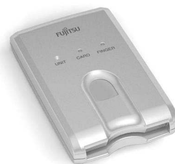
図-9 指紋認証付ICカードリーダー Fig.9-IC-card reader with fingerprint authentication.
