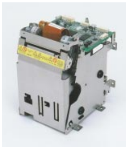
写真2 レシートユニット外観
