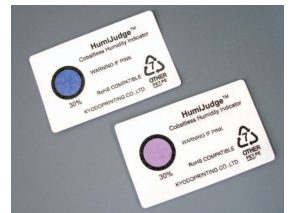
青からピンクへ色相変化したヒューミジャッジ
