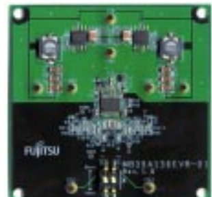
写真3 MB39A136評価ボード (6.5cm × 6.5cm)
