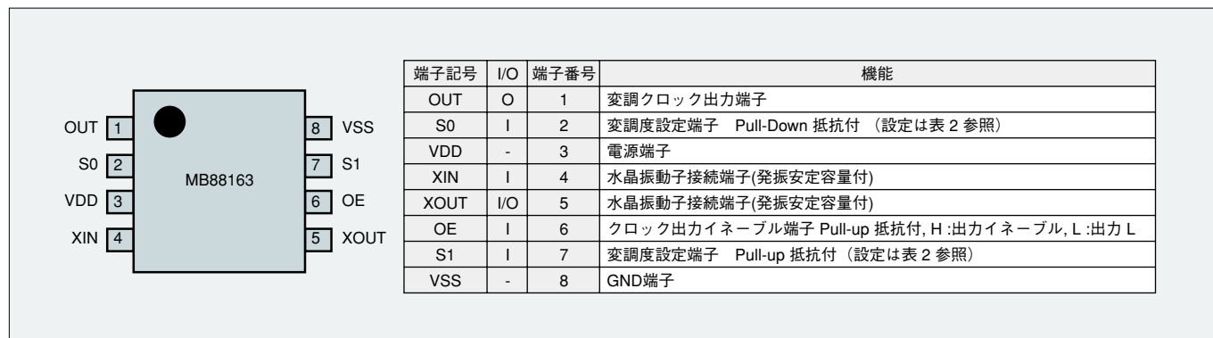
図5 MB88163端子配列図 (TSSOPパッケージ)
