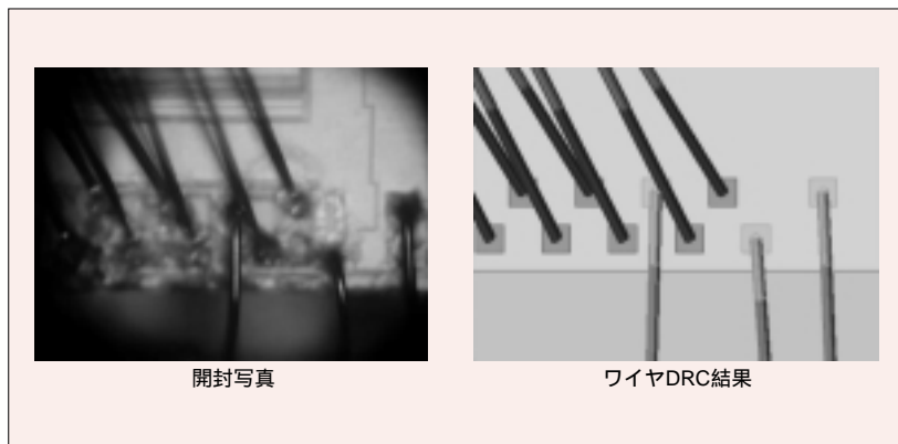
図5 三次元配線シミュレーション例
