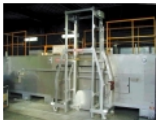
有機肥料生成システム(沼津工場)
